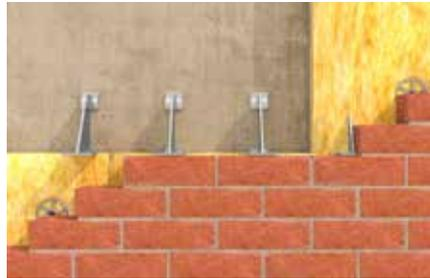
Dämmstoffe in zweischaligen Außenwänden
