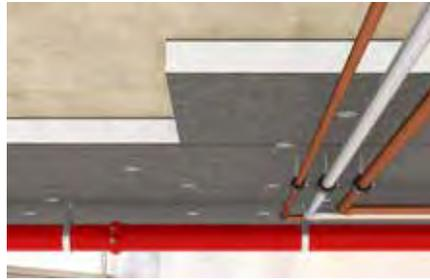
Nichtbrennbare Holzwolle-Leichtbauplatten an der Deckenunterseite
