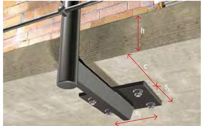
**Die Bohrlochtiefe** muss – bis auf einige Ausnahmen, z. B. Injektionstechnik – größer sein als die Verankerungstiefe. Denn nur dann, wenn der Dübel genug Platz hat, um ordnungsgemäß gesetzt zu werden, ist die Funktionssicherheit gewährleistet. Deshalb immer die Angaben der Montageanleitung beachten.
