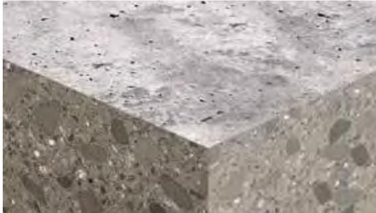
Der Baustoff oder Ankergrund. Unterschieden wird zwischen Beton, Mauerwerk und Plattenbaustoffen. Beton ist ein Baustoff, der aus einem Gemisch aus Zement, Zuschlagstoffen und Wasser besteht.
