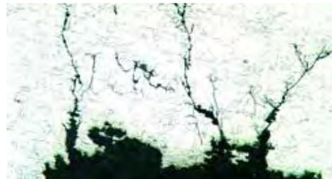
Beispiel für transkristalline Spannungsrisskorrosion an 1.4401 bei starker Chloridbelastung
