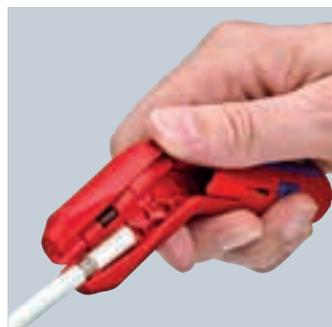
Abmanteln eines Koaxialkabels
