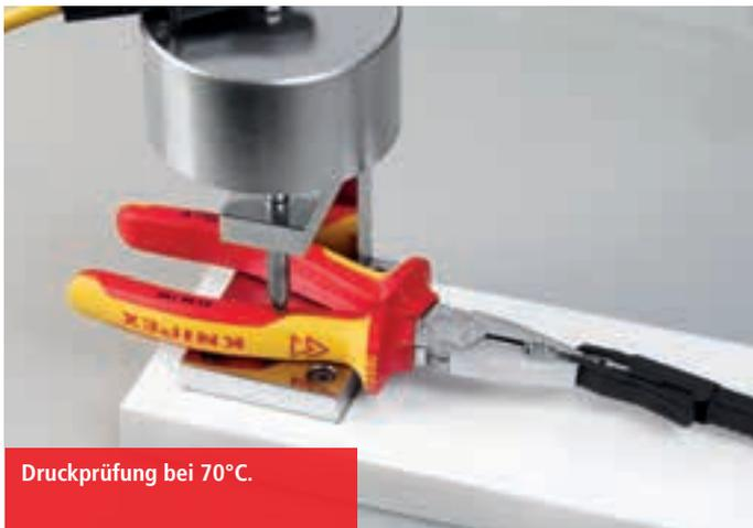
Druckprüfung bei 70°C.
