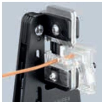
12 12 02 mit Kabelführung und Längenanschlag
