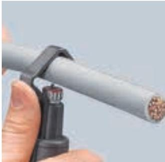
Ansetzen des Werkzeugs für Umfangsschnitt
