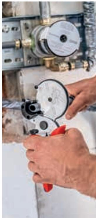
Der Rohrschneider schneidet alle gängigen Verbund- und Kunststoffrohre mit einem Durchmesser von bis zu 26 Millimetern. Durch seine robuste Bauweise ist er auch für Verbundrohre mit erhöhter Aluminiumschichtdicke geeignet.
