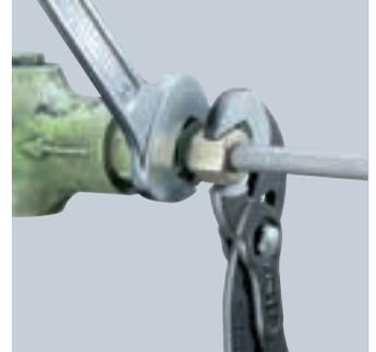
Selbstklemmend: kein Abrutschen am Werkstück, weniger Kraftaufwand
