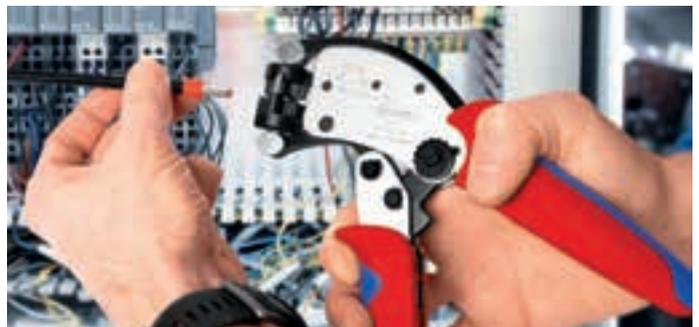
360° drehbarer Crimpkopf für beste Zugänglichkeit auch unter beengten Verhältnissen
