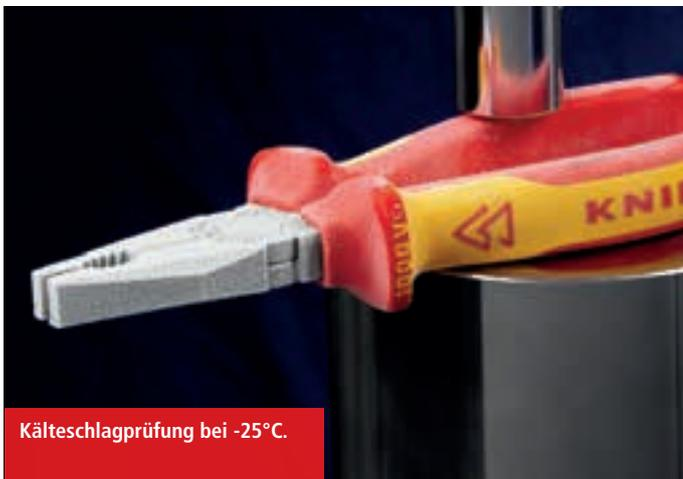
Kälteschlagprüfung bei -25°C.
