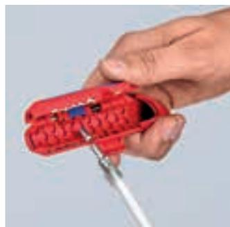
Abisolieren eines Koaxialkabels
