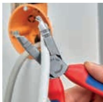
Schneiden von Kabeln bis Ø 13 mm
