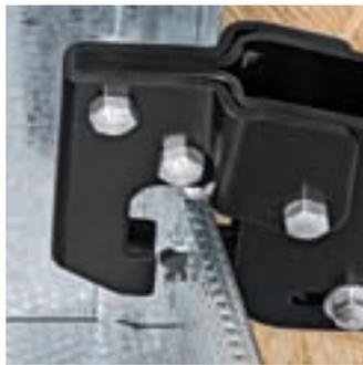
Das Stempelwerkzeug wird durch die Profilbleche gedrückt
