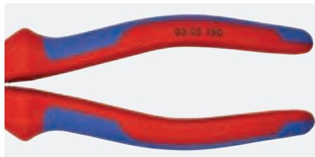
**Mehrkomponenten-Hüllen** Im Vergleich zu Griffen mit dünnem Kunststoffüberzug, bieten die Komfort-Griffe der Hand eine größere Auflagefläche und sorgen so für eine bessere Kraftverteilung und dadurch für ein angenehmeres Arbeiten. Die rote, harte Komponente sorgt für festen Halt am Zangenkorpus, die weichere blaue für ergonomischen Kontakt zu Fingern und Handballen.
