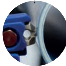
Einmal eingesetzt, übt die federbelastete Klinge genug Druck für den Schnitt aus – kein Nachjustieren nötig!
